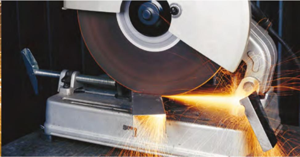
I troncatori **GLOBE** per macchine stazionarie leggere **CHOPCUT** permettono di tagliare profilati, tubi ed anche sezioni piene di pezzi aventi diametro massimo di 30/40 mm.
