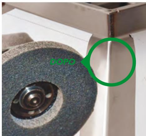
Prima (SN) e dopo (DX) il passaggio di SHINING su un semilavorato in ACCIAIO INOX.
