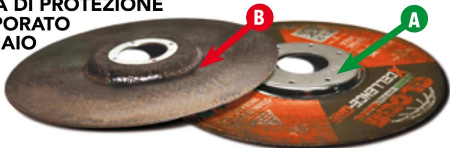
La cupola metallica **A** del disco **X-CELLENCE ONE** garantisce maggiore sicurezza, evita di danneggiare il centro depresso **B** e riduce le vibrazioni, aumentando la precisione e la rigidità del taglio.
