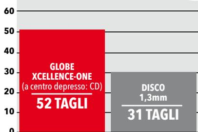
Test di taglio in laboratorio eseguiti con batterie cariche al 100% ed in comparazione con dischi piani 125x1,3x22,23mm.
