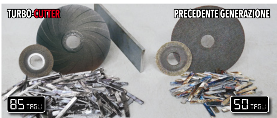
A destra: il risultato finale dei test di laboratorio comparativi su barre di acciaio 2x1/4", tagliate con dischi da 125mm.
